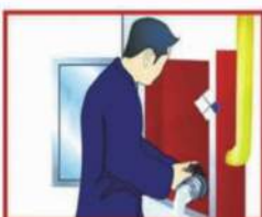
5. 另外一人打开消防栓上的水阀开头
